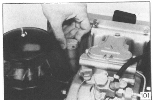
**ATTENZIONE:** per accertarsi, senza attrezzatura, che la taratura della pompa iniezione sia esatta, praticare al motore alcune accelerate a vuoto, osservando lo scarico. Riscontrando molto fumo, occorre ridurre la mandata di nafta; non riscontrando alcuna traccia di fumo allo scarico, la mandata è scarsa, per cui occorre incrementarla. La mandata nafta, sarà corretta, quando lo scarico, in seguito ad accelerata, risulterà leggermente increspato di fumo.
