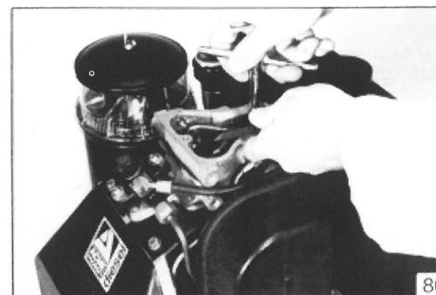
**9.25 MONTAGGIO POMPA INIEZIONE**
