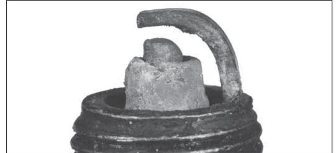
Bei einer verschlissenen Zündkerze ist die Mittelelektrode abgerundet und der Elektrodenabstand größer als vorgeschrieben. Ersetzen Sie eine verschlissene Zündkerze sofort.
