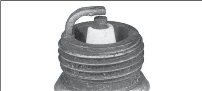
Weiße kalkartige Ablagerungen sind Anzeichen für zu hohe Verbrennungstemperaturen. Meistens sind in diesem Fall auch die Elektroden sehr stark verschliffen. Hohe Verbrennungstemperaturen werden durch ein zu mageres Luft/Kraftstoff-Verhältnis, Falschlufansaugung oder einen nicht korrekten Zündzeitpunkt verursacht.
