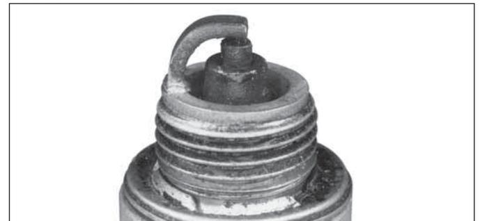
Eine nasse Zündkerze ist das Ergebnis von zu viel Kraftstoff oder Öl im Brennraum. Überschüssiger Kraftstoff kann durch einen verstopften Luftfilter, ein Vergaserproblem oder den Betrieb des Motors mit zu viel Choke verursacht sein. Öl im Brennraum wird normalerweise durch einen verstopften Luftfilter, ein Entlüfterproblem oder durch verschlissene Kolbenringe oder Ventilführungen verursacht.
