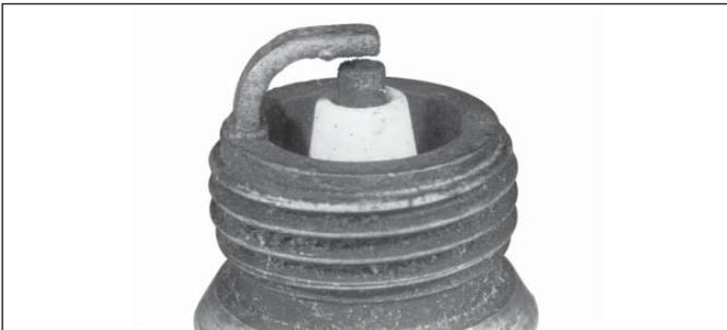
Weißer kalkartige Ablagerungen sind Anzeichen für zu hohe Verbrennungstemperaturen. Meistens sind in diesem Fall auch die Elektroden sehr stark verschliffen. Hohe Verbrennungstemperaturen werden durch ein zu mageres Luft/Kraftstoff-Verhältnis, Falschlufansaugung oder einen nicht korrekten Zündzeitpunkt verursacht.
