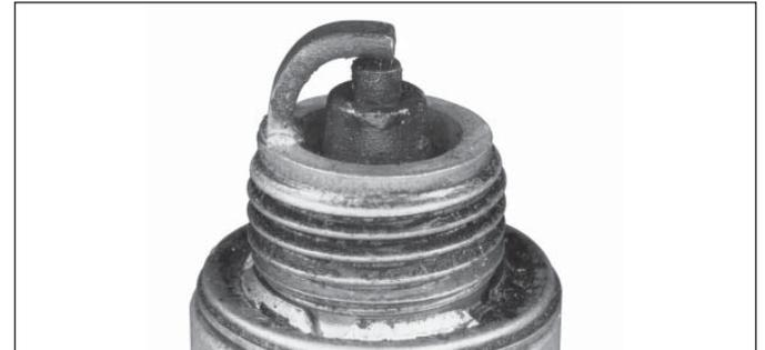
Eine nasse Zündkerze ist das Ergebnis von zu viel Kraftstoff oder Öl im Brennraum. Überschüssiger Kraftstoff kann durch einen verstopften Luftfilter, ein Vergaserproblem oder den Betrieb des Motors mit zu viel Choke verursacht sein. Öl im Brennraum wird normalerweise durch einen verstopften Luftfilter, ein Entlüfterproblem oder durch verschlissene Kolbenringe oder Ventilführungen verursacht.
